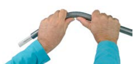
Гибка с помощью внешней гибочной пружины
